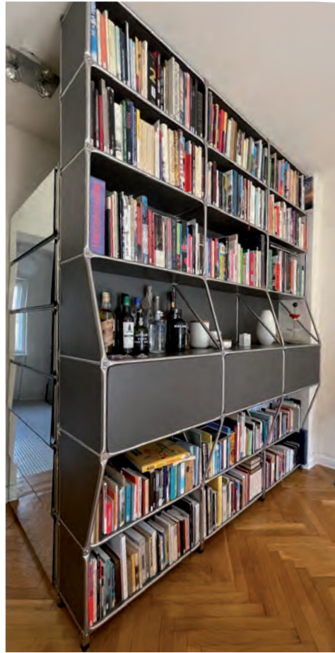
▲ Regal mit Anrichte , 2014 Berlin-Westend, Foto 9. März 2021 Edelstahlrohr 20/1 mm, Füllungen aus MDF
