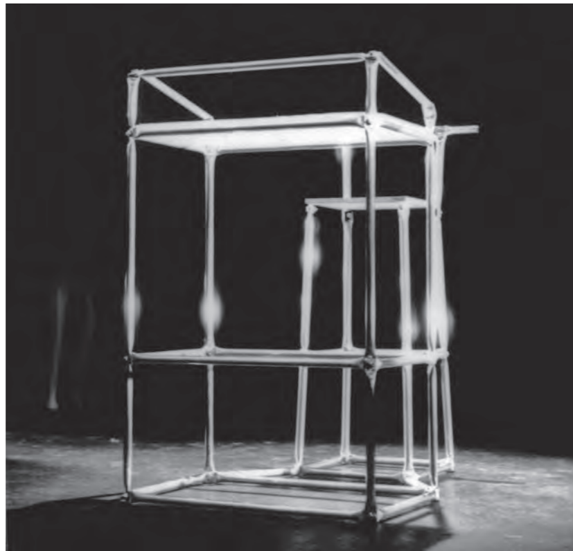
▶ ▲ Erste statische Bewährungsprobe des Systems bei der Veranstaltung ›Zeitgeist – Internationale Kunstausstellung‹ 1982 im Martin-Gropius-Bau: Bei der Brunnenskulptur aus Bronze von Sandro Chia und Enzo Cucchi versagten kurz nach Inbetriebnahme einige Wasserauslässe. Zur Reparatur konnte die Zwei-Tonnen-Plastik in der Nordrotunde mit der filigranen Konstruktion aus 25 mm Stahlrohr angehoben und repariert werden. Bernd Braun und Christoph Schwarz bedienen die Greifzüge.
