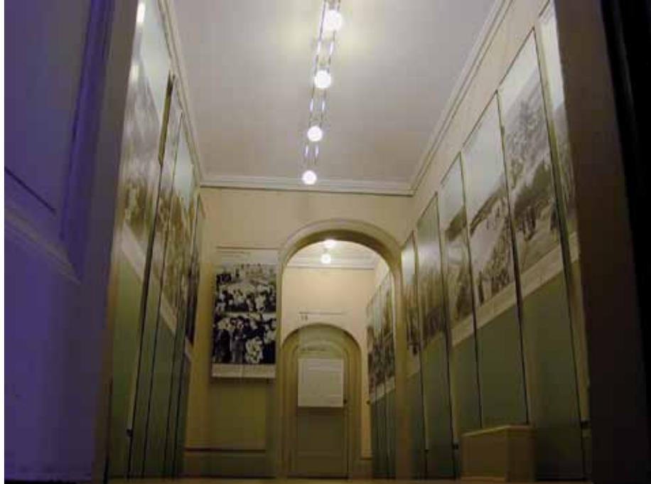
Vielfach gelobt wurde das Beleuchtungssystem, das – der Atmosphäre und den architektonischen Vorgaben der Villa verpflichtet – mittig im jeweiligen Raum hängt und mit Kompaktleuchtstofflampen ein blendfreies, gleichmäßiges Licht gewährleistet.
