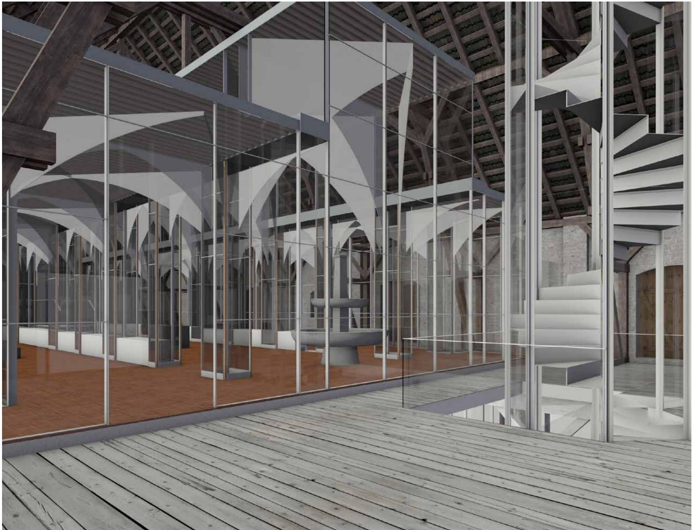
von tragenden Elementen vermieden, fasst die beiden Etagen bei dieser Variante zweifach zusammen: einmal innerhalb des temperierten Luftraums und einmal im südlichen Kaltraum. Mehrere, zum Teil vorhandene Durchbrüche im Boden des Obergeschosses vermitteln spannende Durchblicke und sind Teil des klimatischen Konzepts.
