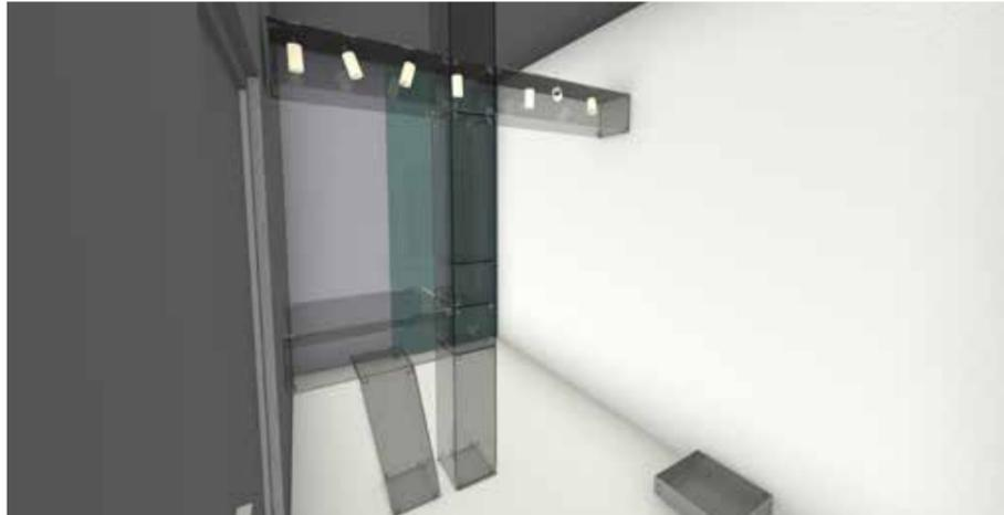
Kapitel 4 im kleinsten Raum des Rundgangs wurde ausgewählt, um dort die Fachwerkvittrinen schon während der laufenden Gebäudesanierungsarbeiten zu erproben. Neben der Idee, das Fachwerk der Außenwand ins Rauminnere zu projizieren, wurden Glasverbinder aus Edelstahl entwickelt, die in der Konfiguration von vier aneinanderstoßenden Ecken das Bild eines Mühlrades zeigen. Der Auftritt dieser Verbinder ist zu dominant, sodass sie für die restlichen Räume stark vereinfacht wurden.
