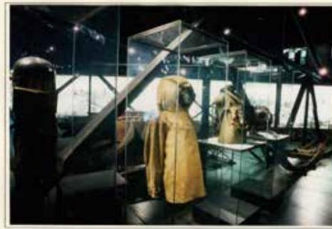
In diesem Zusammenhang ist als Besonderheit die Vitrinenkonstruktion hervorzuheben. Aus gleichen Scheiben lassen sich durch Addition von Grundsockeln und Deckelrahmen Vitrinen in beliebiger, rechtwinkliger Form herstellen.
