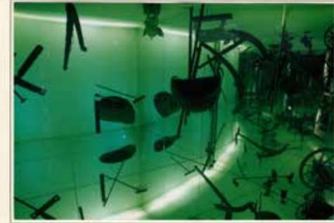
Verbundsicherheitsglas wird beispielsweise für Windschutzscheiben in Autos verwendet, auch bei Banken und bei der Post im Schalterbereich eingesetzt, es splittert im Gegensatz zu Einschleibensicherheitsglas nicht und das es weicher ist, stört bei jenen Anwendungen nicht, bei uns war diese relative Weichheit allerdings ein Nachteil.
