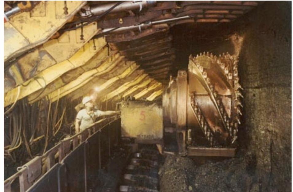
Abbau mit der Schrämmaschine
